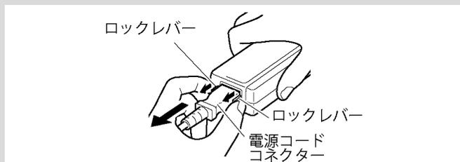
電源コードコネクタには抜け防止のロック機構が備わっています。電源コードを AC アダプターの電源コードコネクタ差込口から抜く際は、電源コードコネクタ左右のロックレバーを引きながら抜いてください。
