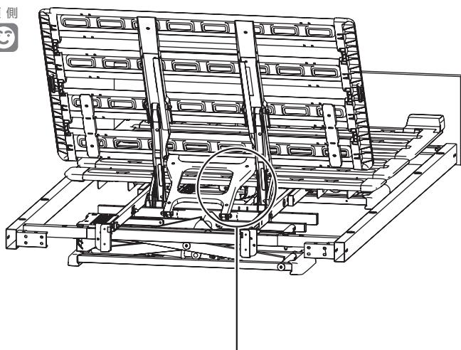
⑤ 背アクチュエーター先端の連結ピンについているスナップピン(赤)を取外す。
