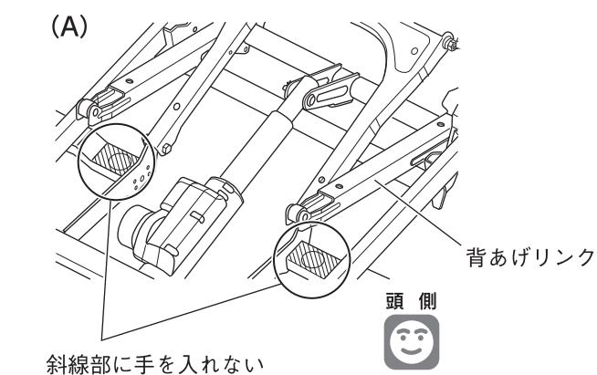
■停電時やベッドの故障により、背ボトムがさげられなくなったりした場合、手動で背ボトムをさげることができます。背さげ操作は、以下の手順で行ってください。
