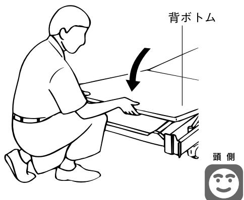
■ 背ボトムがあがっている状態で、停電やベッドの故障により背ボトムがさげられなくなつた場合、手動で背ボトムをさげることができます。背さげ操作は、以下の手順で行ってください。停電以外の理由で背さげができなくなった場合、45・46ページ「13. 故障かな?と思つたら」に従つてチェックしてください。ベッドが故障している場合には、販売店もしくはパラテクノコールセンター(48ページ参照)までご連絡ください。
